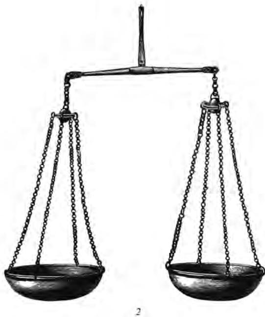
*Рис. 2: 1. Рычажные весы — «безмен». 2. Равноплечные весы — «скалвы».*
