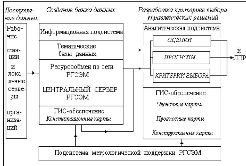
Рис.1.1 Функциональная схема структуры РГСЭМ. Поступление информации: с сетей ведомств, с опорных полигонов, с сети МчСО, данные служб космического мониторинга, сетей ЕГСЭМ и InterNet, данные прочих абонентов.
