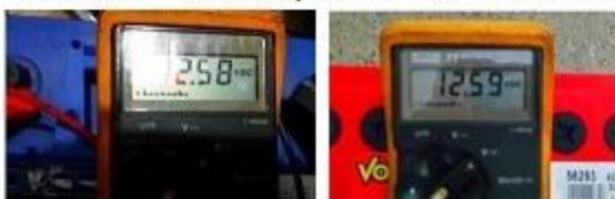
Рис.8. Измерение напряжения на клеммах аккумуляторов.
