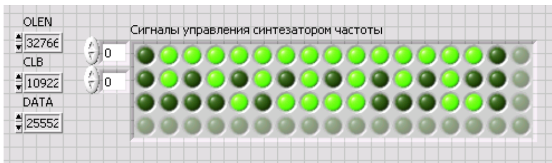
Рис.4. Фрагмент лицевой панели программатора СЧ
