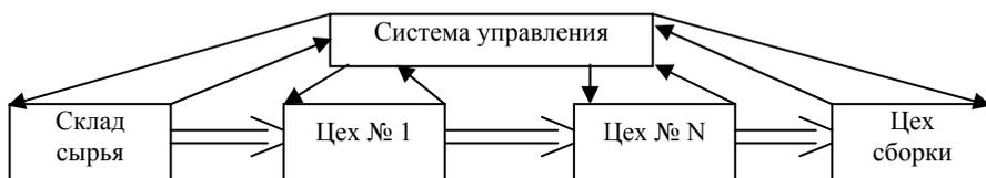
Рис. 6. Толкающая система
