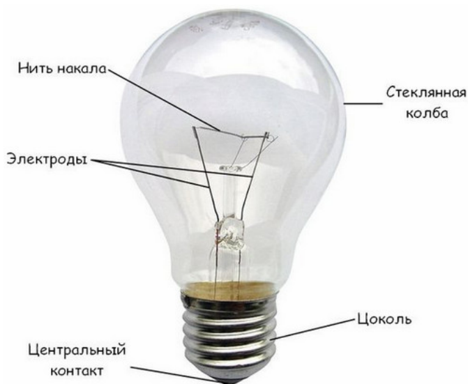
Рисунок 5. Лампа накаливания (лампа общего назначения — ЛОН)
