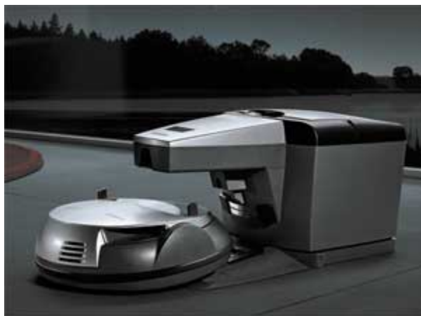
Рисунок 15. Пылесос-робот с базовой станцией
