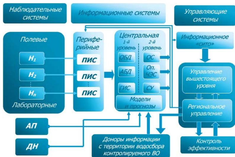
**Рис.2.** Региональная система мониторинга водных объектов (разработка ГЦВМ и ИВП РАН для Чувашии). Информационные потоки. АБД – архивная БД; АП – автоматические посты; ВО – водный объект; ГИС – геоинформационная система; ДН – дистанционные наблюдения; Н – наблюдательная подсистема; ОБД – оперативная БД; ОС – оперативная сводка; Оп.ЧЭС – оповещение о чрезвычайной экологической ситуации; ПИС – периферийная информационная система; СУ – сценарии управления
