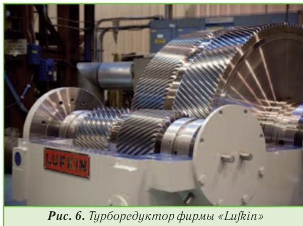
**Рис. 6.** Турборедуктор фирмы «Lufkin»
