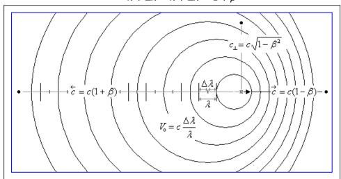
Характер распространения света от движущегося источника излучения. Скорость света выражена относительно источника излучения.
