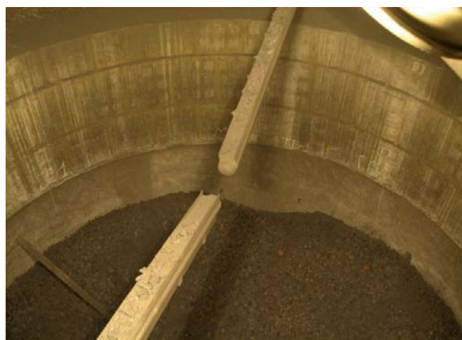
Рис. 4. Влияние термозондов на формирование окружной неравномерности поверхности засыпи шихты (поверхность засыпи шихты после выгрузки порции № 104, уровень засыпи 4,1–4,4 м)
