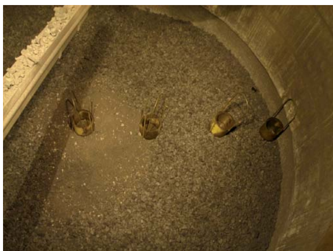
Рис. 5. Установка цилиндрических пробоотборников на поверхности кокса перед выгрузкой исследовательской железорудной порции АОШ 9-4 (№ 1 – ось; № 4 – стенка)
