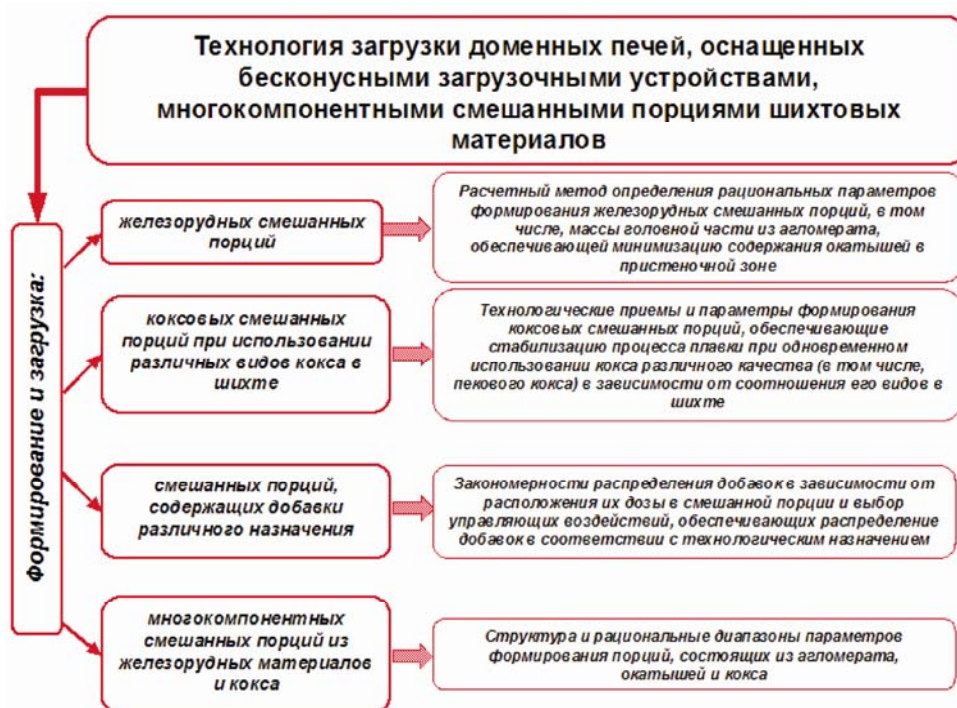
Рис. 7. Блок-схема технологии загрузки доменных печей, оснащенных БЗУ, многокомпонентными смешанными порциями шихтовых материалов
